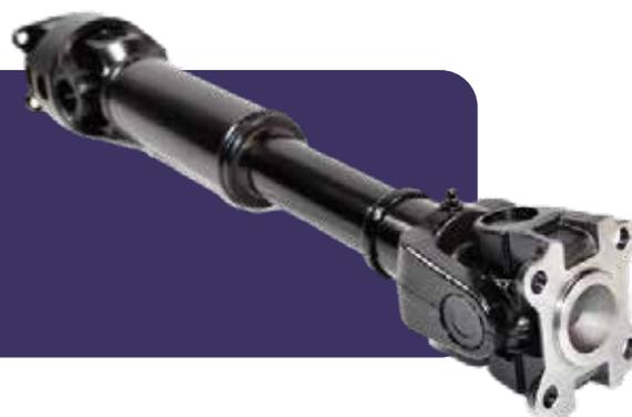
Transmiten el movimiento de salida de la caja de transferencia hasta los diferenciales delantero y trasero, en su gran mayoría son huecas, poseen un estriado para que la barra se acorte y se elongue según los movimientos de la suspensión, además, son balanceadas y se añaden elementos como el rol central que actúa como soporte, con el fin de evitar vibraciones durante su giro.
