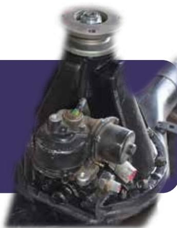
Estos sistemas se controlan mediante un interruptor o botón en la cabina del vehículo. Cuando se activa el bloqueo de diferencial, el sistema envía una señal eléctrica a un actuador en el diferencial, que bloquea mecánicamente el diferencial, haciendo que ambas ruedas del mismo eje giren a la misma velocidad.
