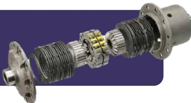
Un diferencial LSD con bloqueo por aceite utiliza un mecanismo especial que ajusta la distribución del par entre las ruedas. Esto se logra mediante el uso de un fluido (aceite) que se calienta cuando el diferencial detecta diferencias significativas de velocidad entre las ruedas. El calor del aceite provoca un cambio en la viscosidad de este, lo que a su vez ajusta la distribución del par.
