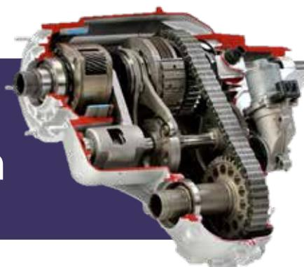
Es el encargado de recibir el movimiento de salida de la transmisión y distribuir el movimiento hacia las barras delantera y trasera en las configuraciones de engranajes de alta (2H y 4H) y baja (4L), así como de bloquear el diferencial central. Es accionado mediante un mecanismo como una palanca en vehículos antiguos o por un motor eléctrico en vehículos modernos.
