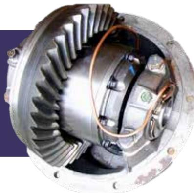
Estos sistemas se controlan mediante una fuente de aire comprimido, como un compresor de aire, que suministra aire a los bloqueos de diferencial. El conductor puede activar o desactivar el bloqueo del diferencial mediante un interruptor o control en la cabina del vehículo.
