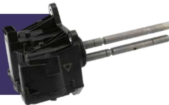
Es el encargado de recibir la señal eléctrica que nosotros ordenamos mediante el interruptor de doble tracción en la cabina, internamente hace los movimientos mecánicos capaces de acoplar las funciones de 2H, 4H y 4L en la caja de transferencia.
