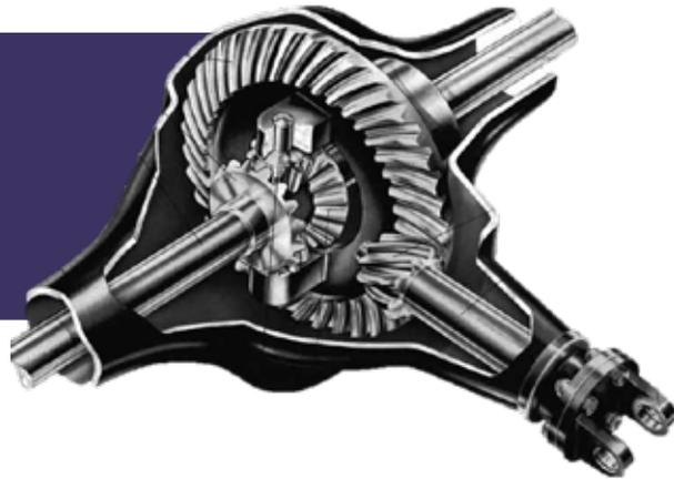
Se encarga de diferenciar las velocidades de giro de las ruedas izquierda y derecha de un mismo eje (eje trasero y eje delantero), esto con el fin de compensar la diferencia de distancia recorrida por la diferencia de los radios de giro de ambas ruedas.
